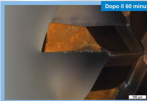
XFeed-H con rivestimento DURO-Si
